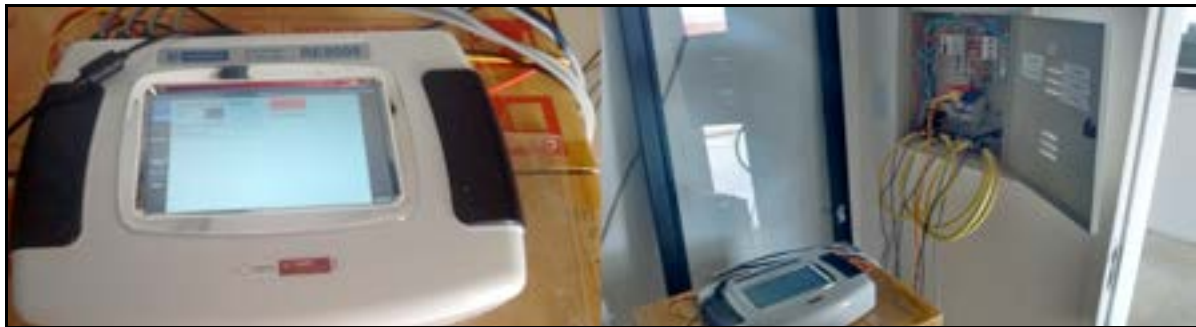
Figura 2: Equipamento para medição de consumo de energia e sua aplicação. Fonte: SERGIPETEC (2018).
